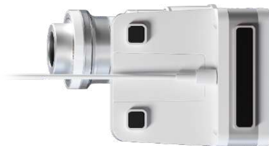
Figura 120: Cabo conectado na parte inferior da base acessória
