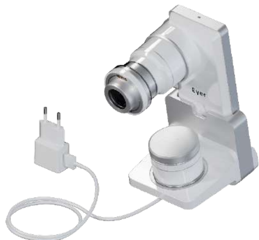
Figura 121: Eyer 2 ® posicionado para carregamento na base acessória.
